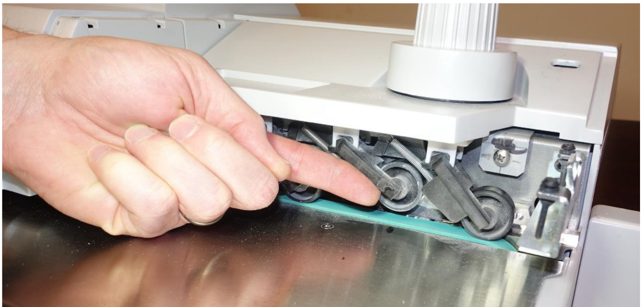
Abbildung 4-16: Reinigung der Walzenrollen
