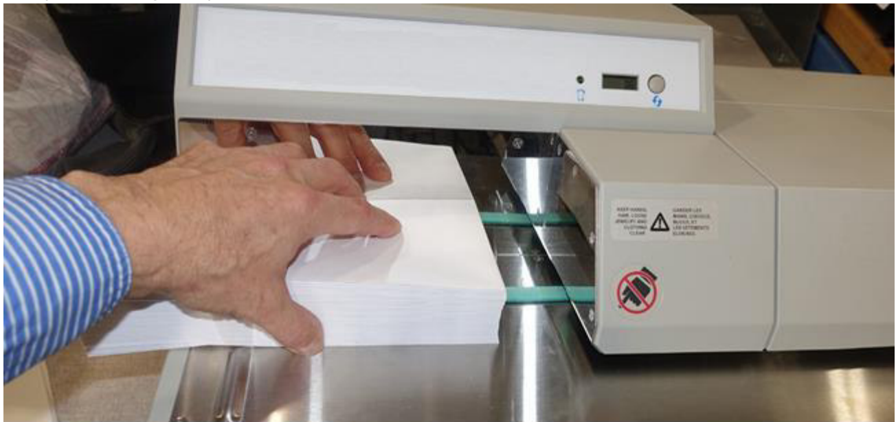
Abbildung 4-6: Beladen des Kuverteinzugfachs
