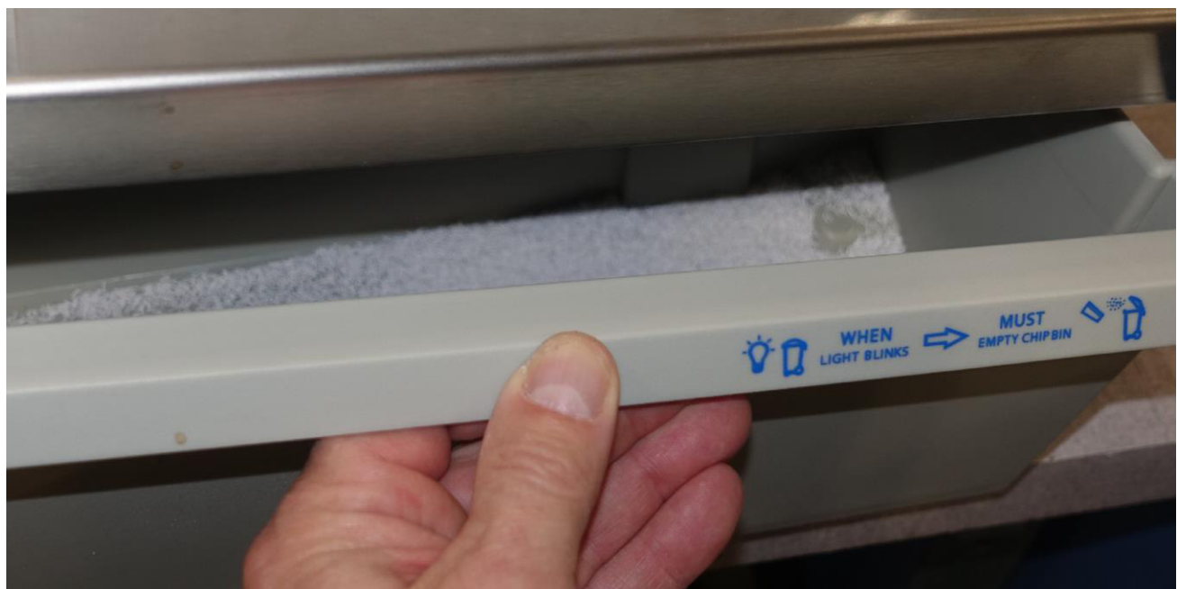
Abbildung 4-3: Öffnen des Schnipsel­fachs
