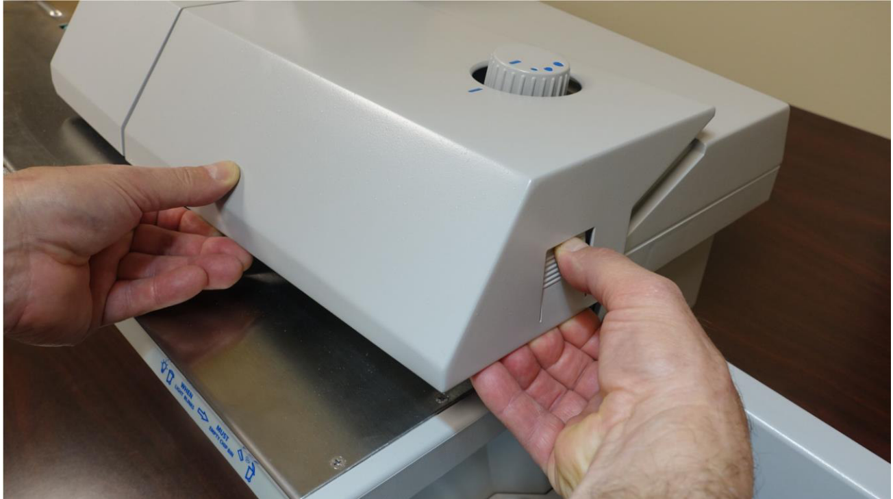
Abbildung 2-7: Auslösung der Verriegelung bei Entfernung der oberen Abdeckung
