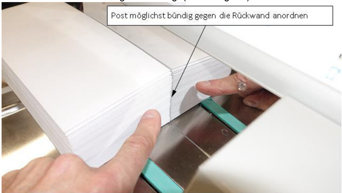
Abbildung 4-7: Post bündig an der Einzugsfachwand
