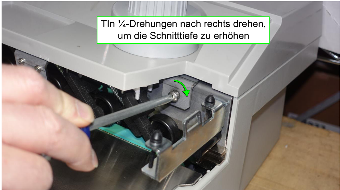
Abbildung 4-18: Tiefenjustierung der Schneidvorrichtung
