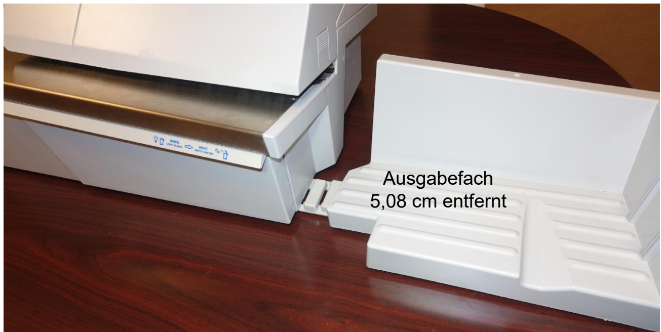
Abbildung 4-12: Ausgabefach 5,08 cm entfernt
